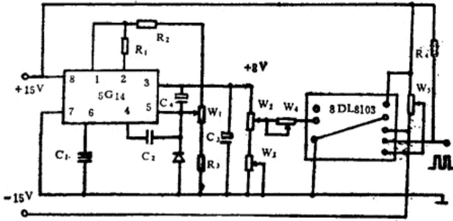
图3.2.30 流向方位传感器电路图
