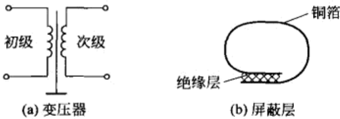
图 6-11 变压器初、次级的屏蔽
