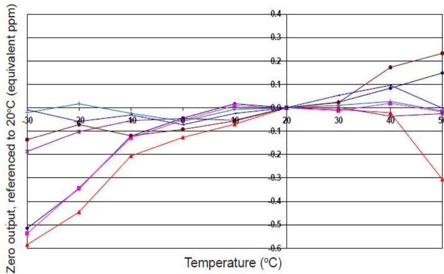
图3 显示了由温度变化引起的零点变化，表示为等效的ppm值，并参考20°C时的零点。
