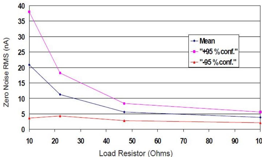
图4显示了负载电阻对噪声的影响。高阻抗电阻会降低传感器噪声，但会线性增加其反应时间。
