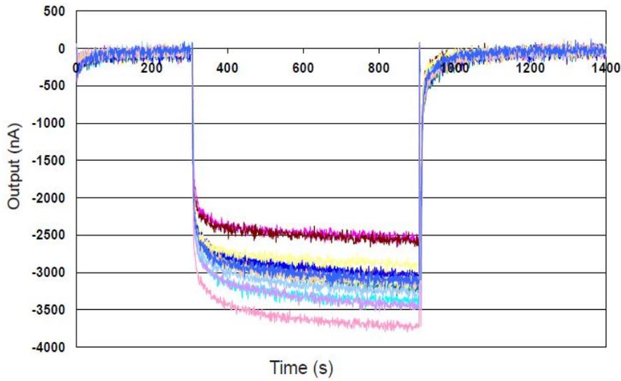
图2显示了传感器对10ppm氯气的反应。
