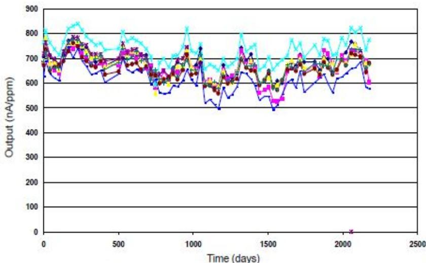
基于已获专利的产品设计、优越的电化学特性以及自动过程控制，H2S-A1传感器表现出优良的灵敏度长期稳定性。如图4所示。
