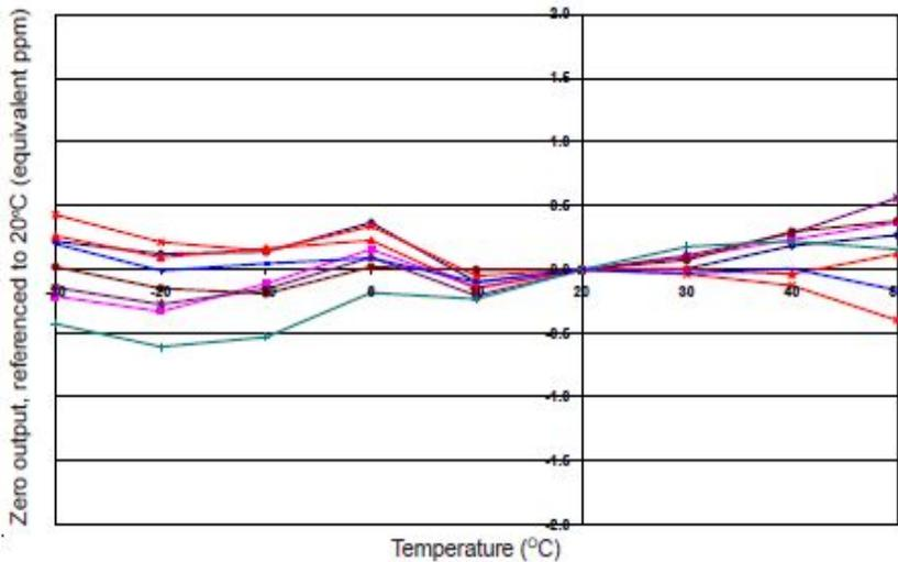
图3显示了由温度变化引起的零点输出变化，表示为等效的ppm值，同时参考20°C时的零点。
