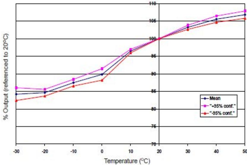
图2显示了由温度变化引起的传感器灵敏度改变。
